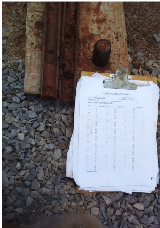
Figura 12 – Amostra SPT-03, profundidade 3m.
